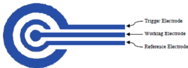
شکل ۲. پایانه‌های سنسور گلوکومتر [۱].
